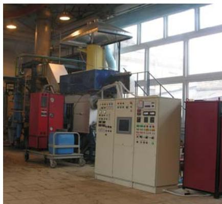
Рис. 1 Внешний вид агрегатов для пароплазменной переработки производительностью 50 и 100 кг/час
