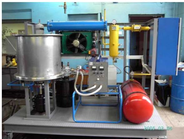
Рис. 2 Внешний вид агрегата для плазменной переработки жидких органосодержащих суспензий
