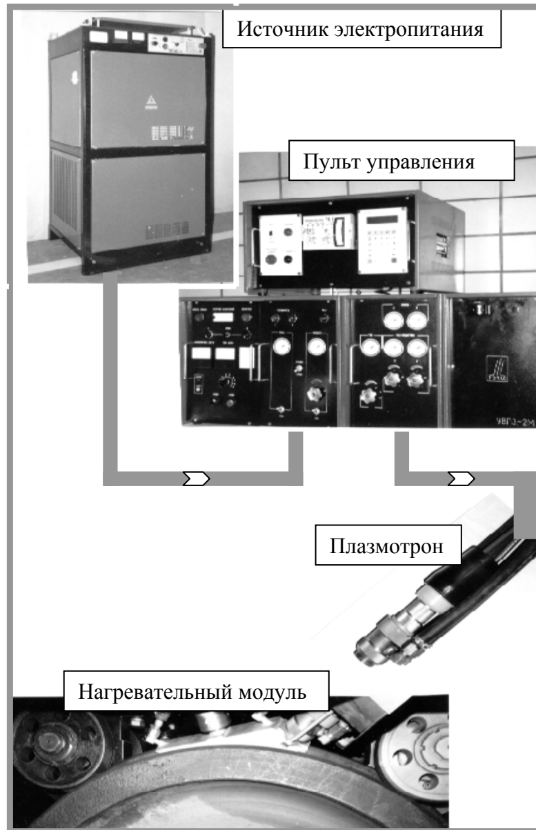
Рис.1. Конфигурация установки плазменного поверхностного упрочнения УВПЗ-2М
