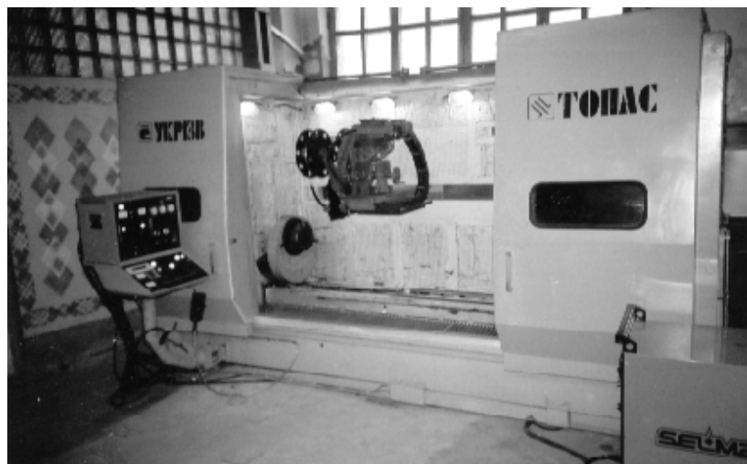
Рис.7. Восстановление коленвала сверхзвуковой электродуговой металлизацией
